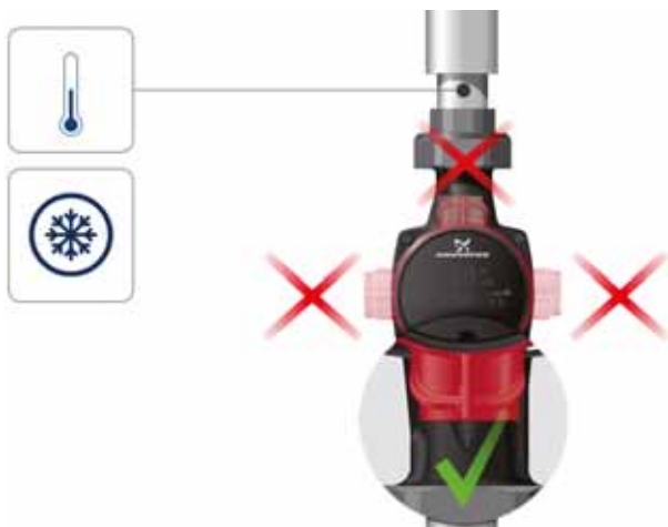
4. ábra Vezérlőegység pozíció légkondicionáló- és hidegvízes rendszerekben
