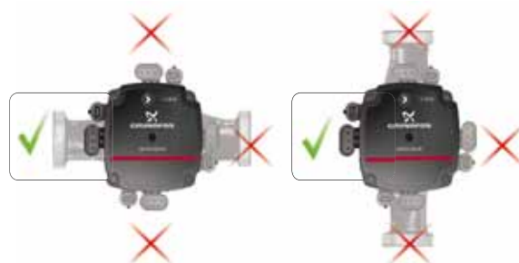
6. ábra Vezérlőegység pozíciók, ALPHA SOLAR
